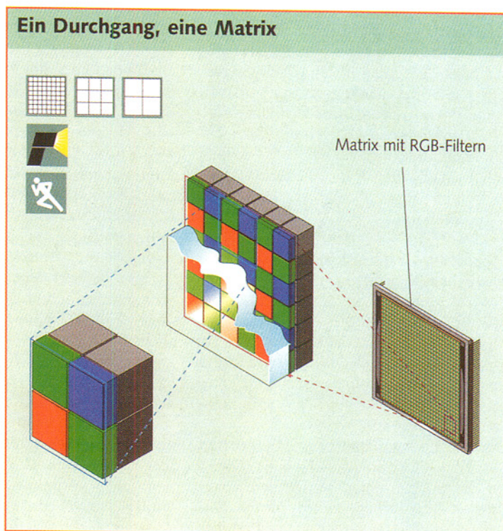
Bild 5: Die Matrixanordnung vieler CCD-Zellen ermöglicht die Bildaufnahme in einem Moment. Grafik: Agfa
